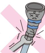
× ネジタイプを取付ける際は、ネジ山をつぶさないように、必ず適正トルクで取付け下さい。必要に応じて、シールテープ等でシール加工を行って下さい。
