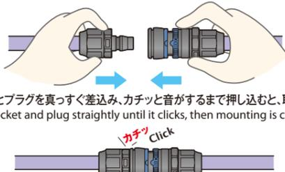
ソケットとプラグを真っすぐ差込み、カチッと音がするまで押し込むと、取付け完了!
