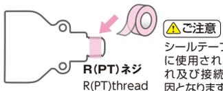
相手側 (メネジ側) に手で仮締めし、スパナ等で締め込んでください。
